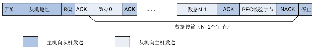
图 26-23. SMBus 主机接收器和从机发送器通信流程
