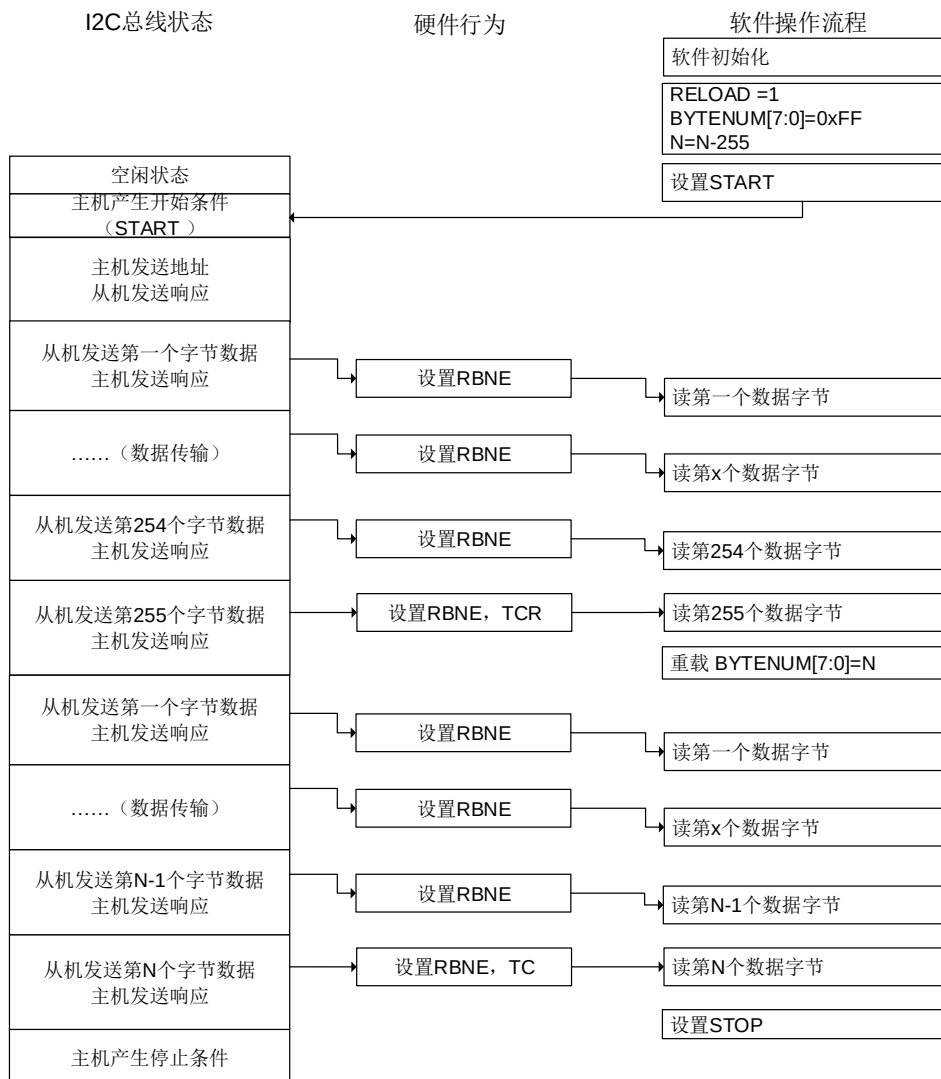
图 26-21. I2C 主机接收编程模型 (N&gt;255)
