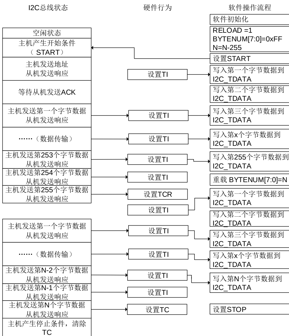
图 25-19. I2C 主机发送编程模型（N>255）
