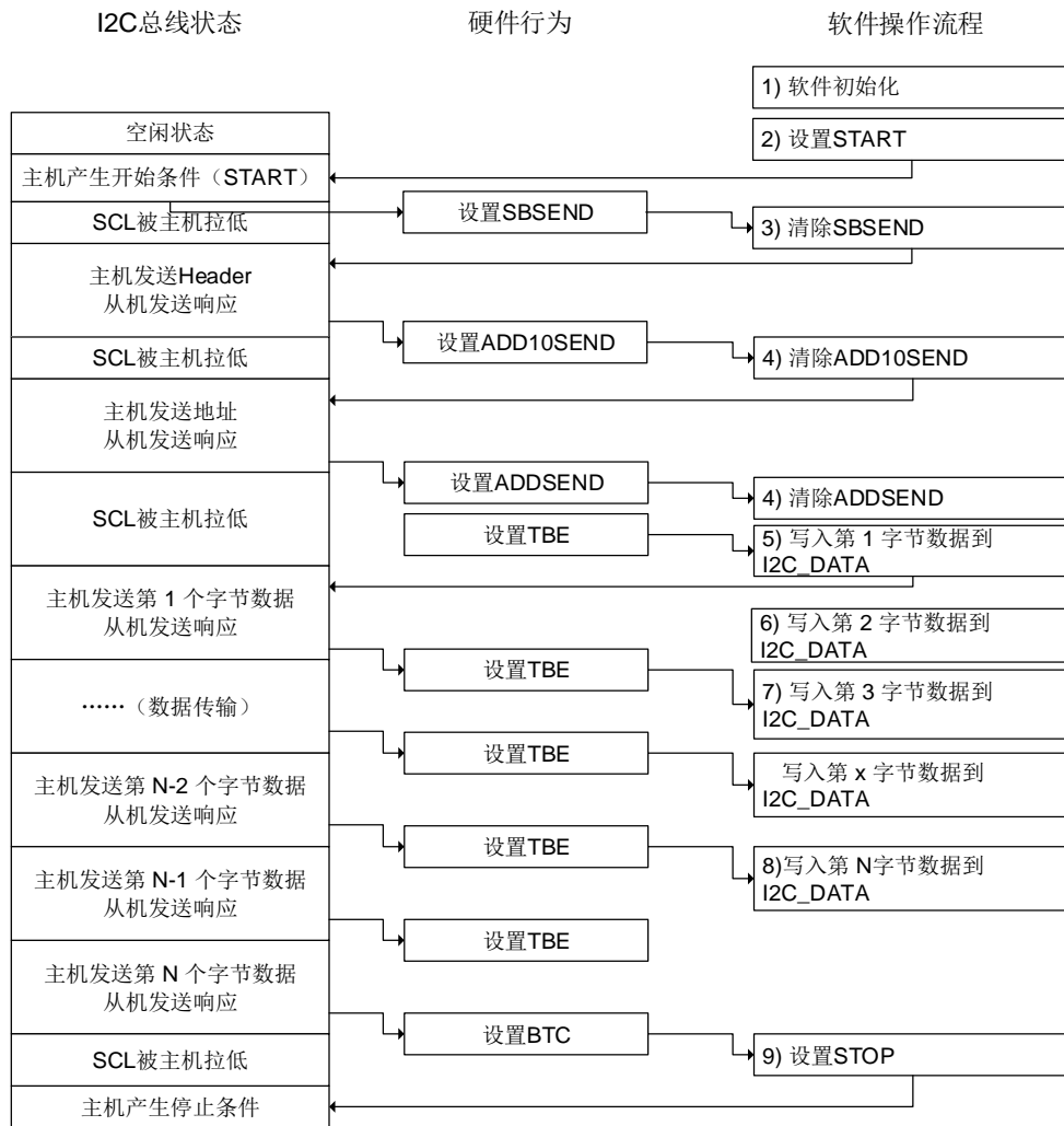
图 18-11. 主机发送模式（10位地址模式）
