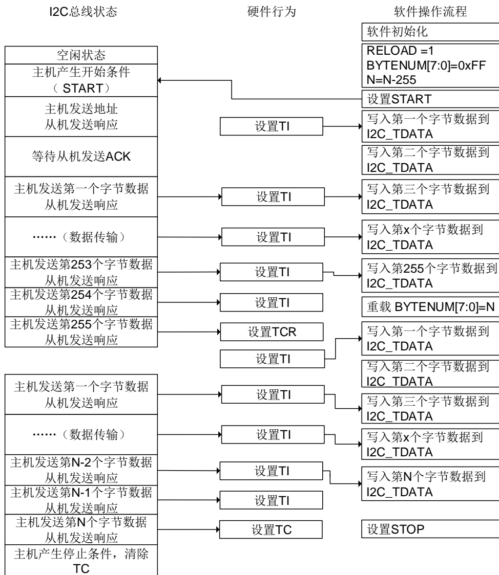
图 21-19. I2C 主机发送编程模型 (N&gt;255)
