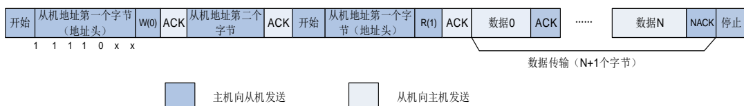
图 19-8. 10 位地址的 I2C 通讯流程（主机接收）
