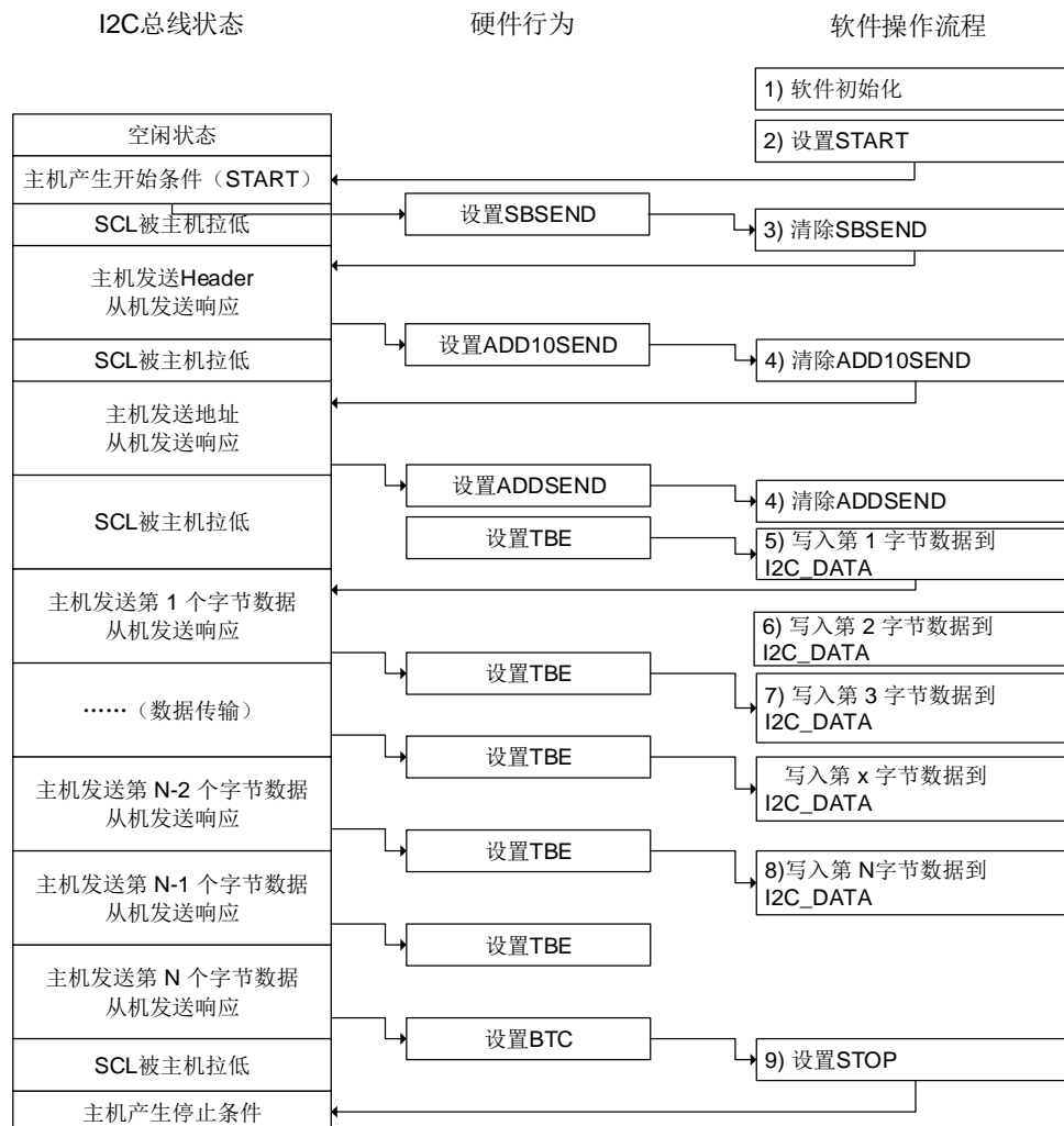
图 17-27. 主机发送模式（10 位地址模式）
