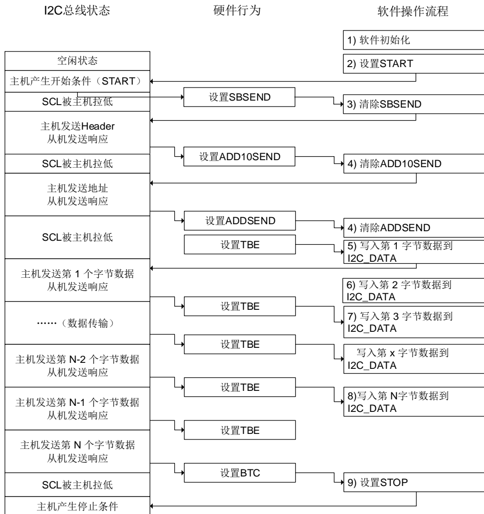
图 17-27. 主机发送模式 (10 位地址模式)
