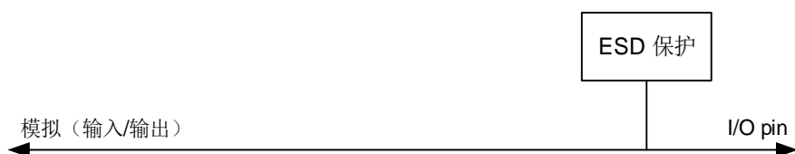
图 6-4. 模拟配置的基本结构
