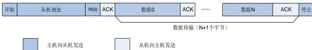
图 19-6. 7 位地址的 I2C 通讯流程（主机接收）
