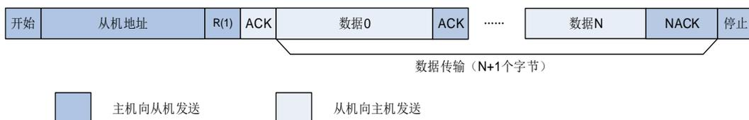
在 10 位寻址模式中，配置 HEAD10R 位可以选择执行完整的寻址序列或只发送地址头。当 HEAD10R=0，执行完整的 10 位地址寻址读序列 START+10 位地址头（写）+第二个地址字节+RESTART+10 位地址头（读），如 [图 19-7. 10 位地址的 I2C 通讯流程（主机接收，HEAD10R=0）](#) 所示。
