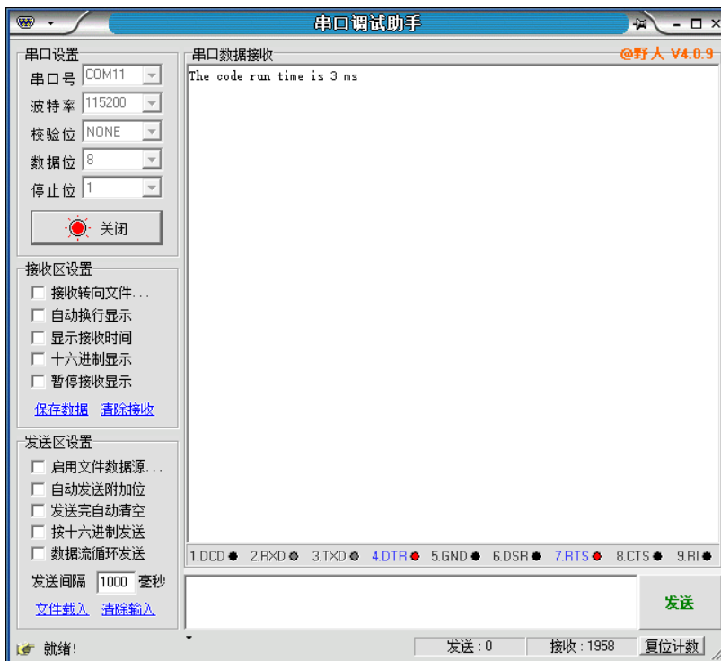
图 2-2. SysTick 测量代码运行时间结果打印
