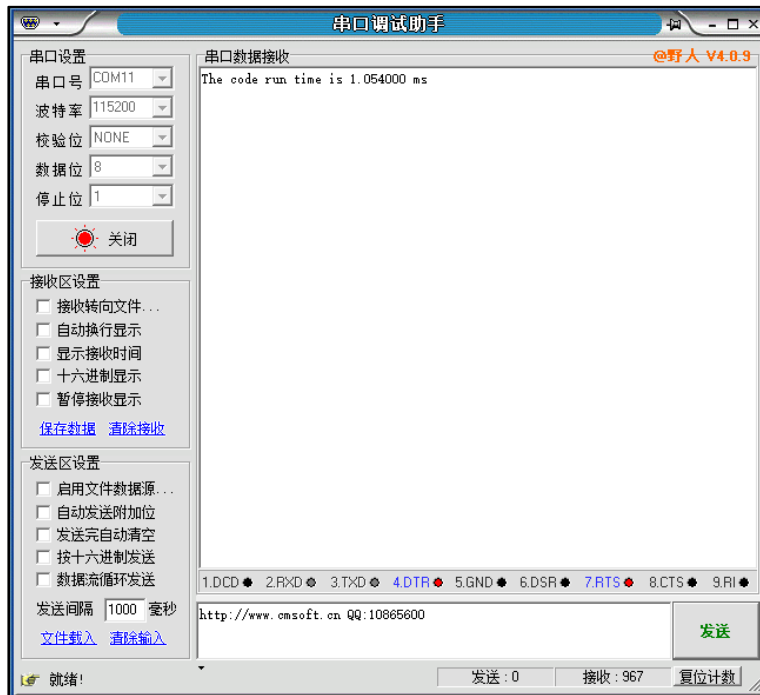
图 2-1. 定时器 Timer1 测量代码运行时间结果打印
