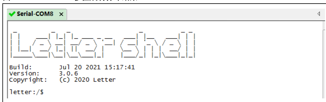
图 4-1. Letter shell 移植成功打印结果
