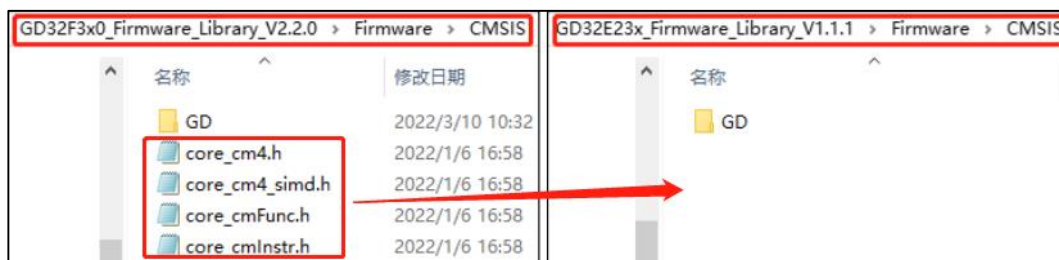
图 7-1. 把 GD32F3x0 固件库中 CMSIS 文件里的.h 文件复制到 GD32E23x 固件库中
