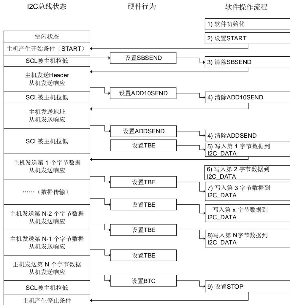
图 18-11. 主机发送模式（10 位地址模式）
