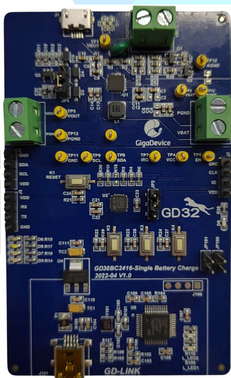
图 1-1 GD30BC2416-Single Battery Charge Demo 实物图
