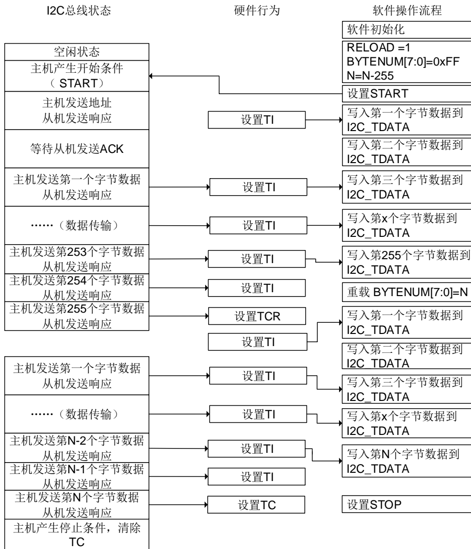
图 24-32. I2C 主机发送编程模型 (N&gt;255)
