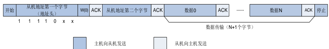
图 24-8. 10 位地址的 I2C 通讯流程（主机接收）
