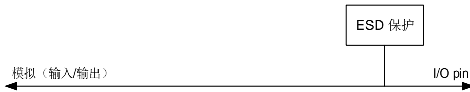
图 8-4. 模拟配置的基本结构
