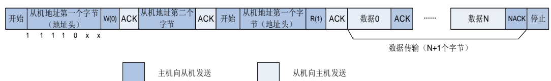
图 24-8. 10 位地址的 I2C 通讯流程（主机接收）
