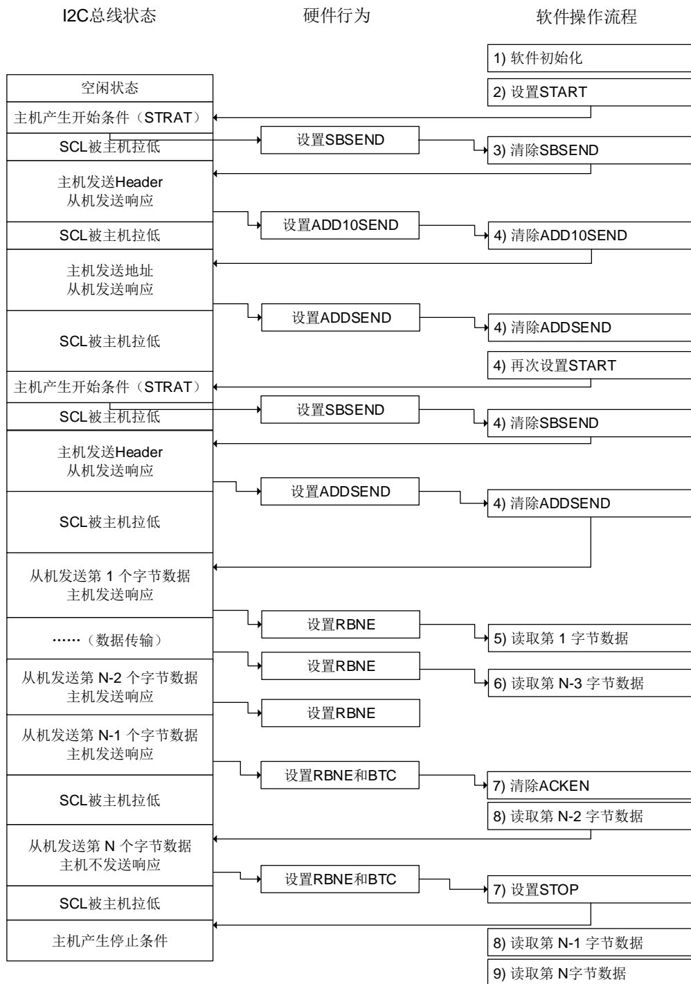
图 24-13. 主机接收使用方案 B 模式（10 位地址模式）
