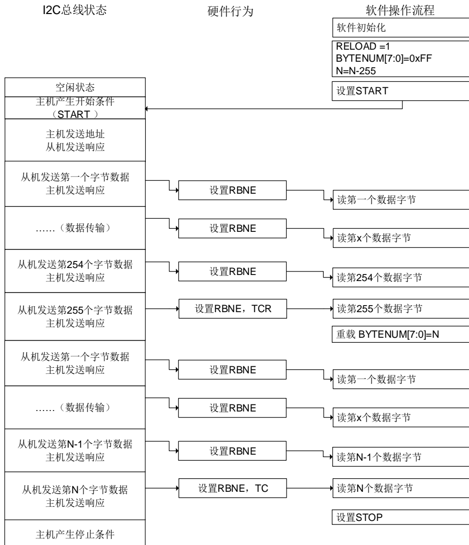
图 20-21. I2C 主机接收编程模型 (N>255)
