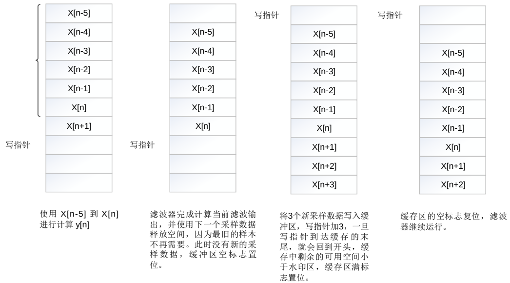
图 35-4. 循环输入缓冲区区域
