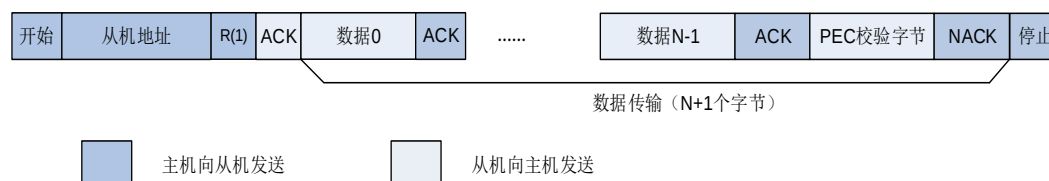
图 28-23. SMBus 主机接收器和从机发送器通信流程
