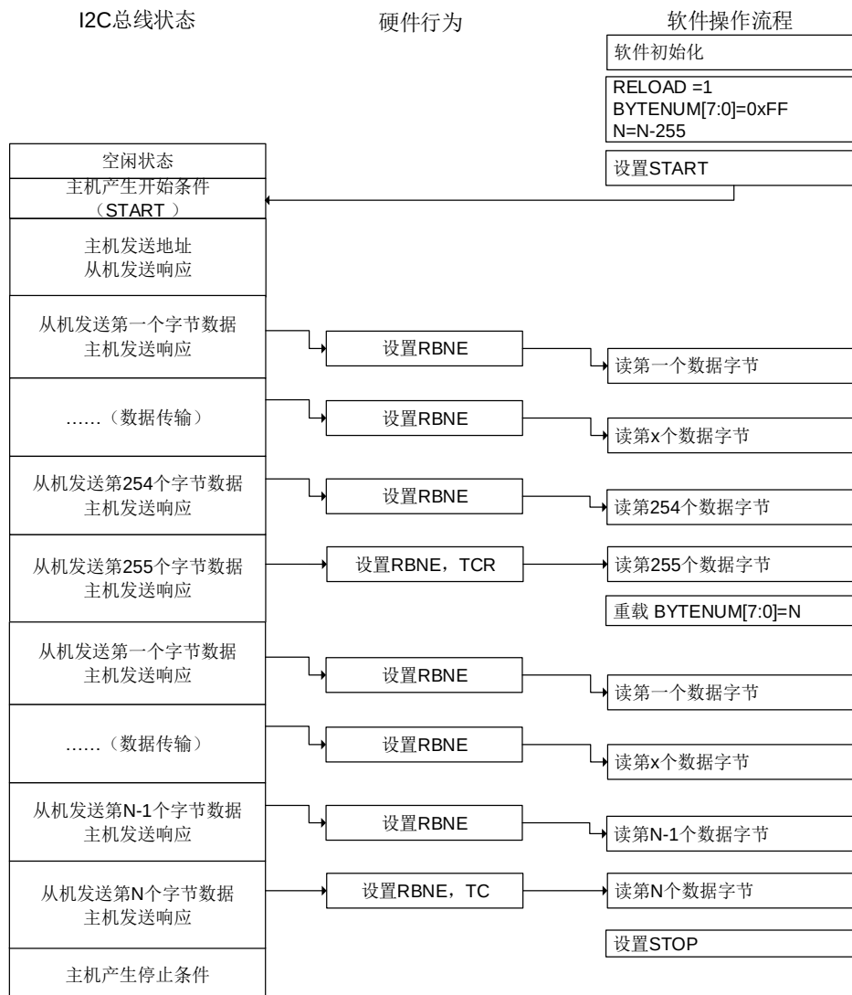
图 28-21. I2C 主机接收编程模型 (N&gt;255)
