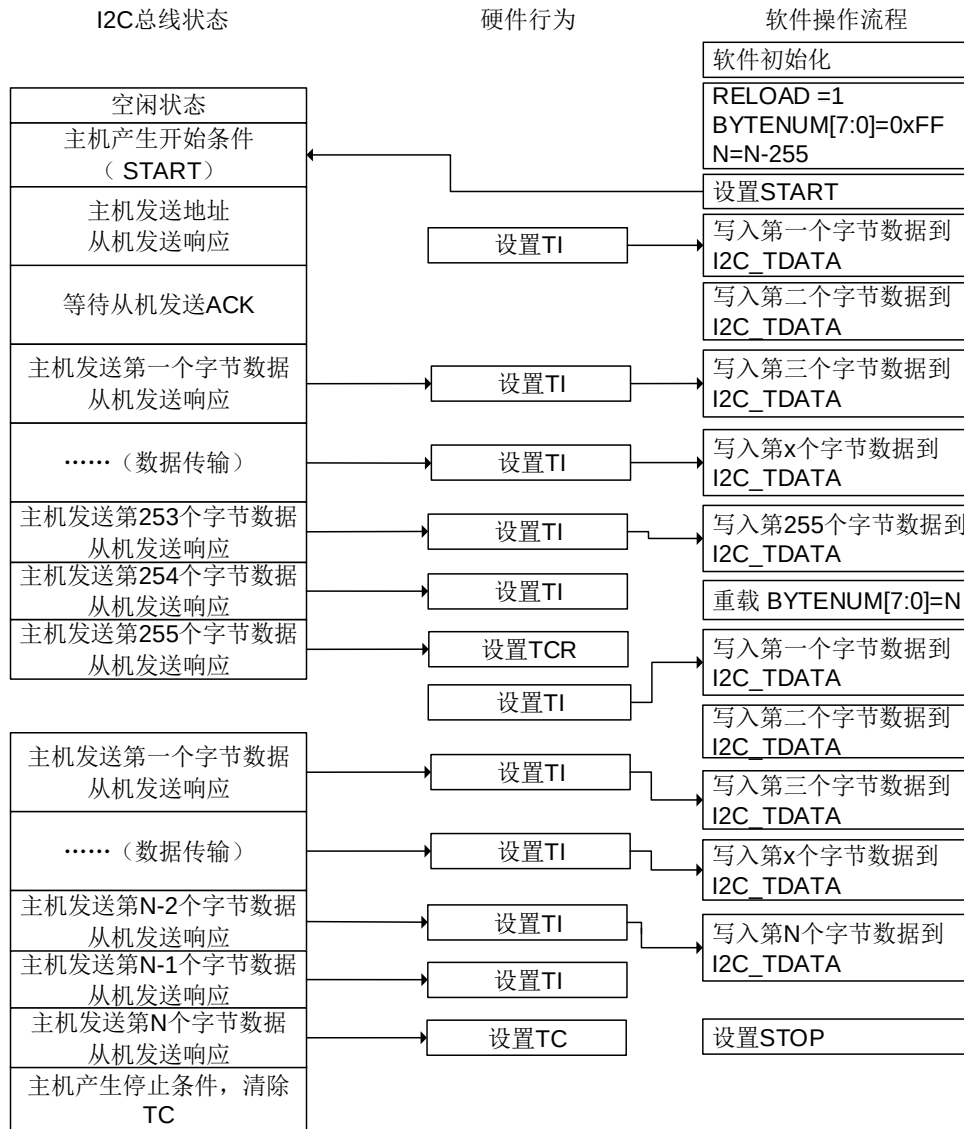
图 28-19. I2C 主机发送编程模型 (N&gt;255)
